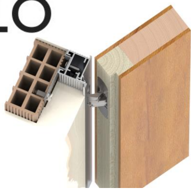
MONTAJE TIPO 1: FILOMURO ATORNILLADO ENRASADO LADO BISAGRAS
